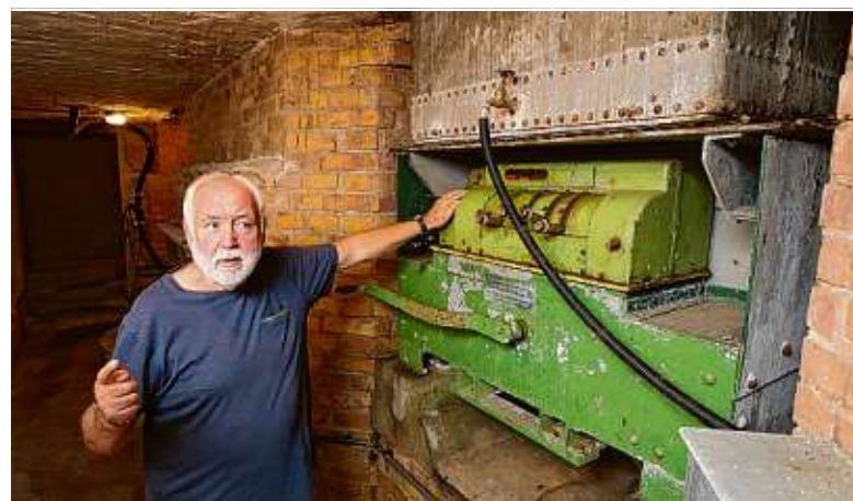
Voll funktionsfähig: eine Wagge aus dem Jahr 1929. Sie befindet sich genau unter dem 1,50 Meter tiefen Lysimeterbehälter im Keller.
