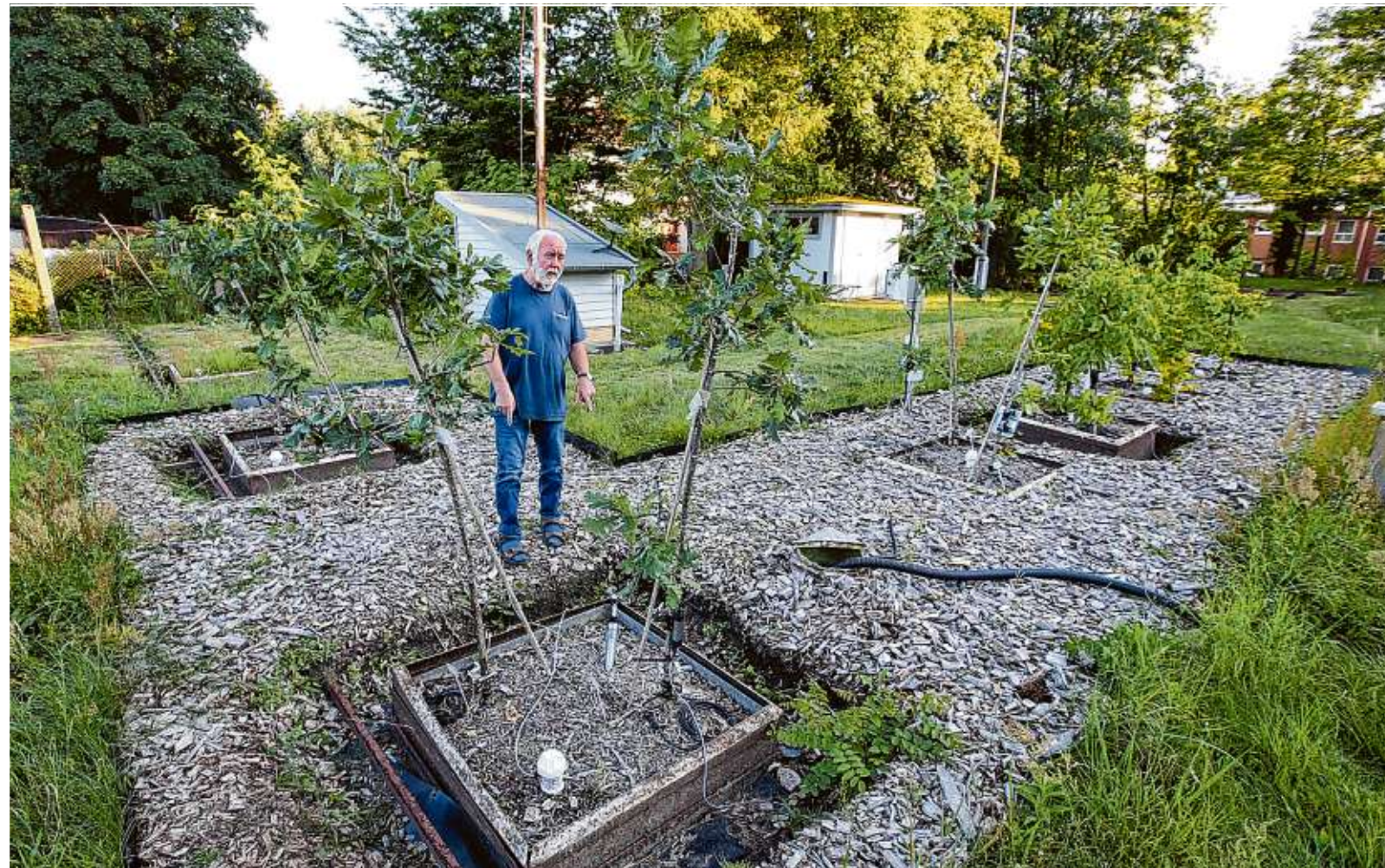
Winterlinde vs. Ungarische Eiche: Seit 2019 laufen unter Leitung von Jürgen Müller die Untersuchungen zur Stressresistenz. Gemessen werden etwa Wasserverbrauch, Verdunstung, Versickerung. Die Lysimeter muten an wie Mega-Blumentöpfe.
